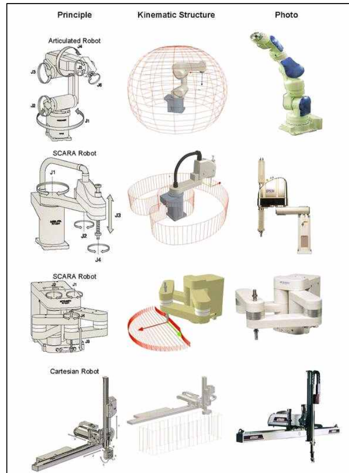
그림 4 기계적 구조에 따른 산업용 로봇 분류
